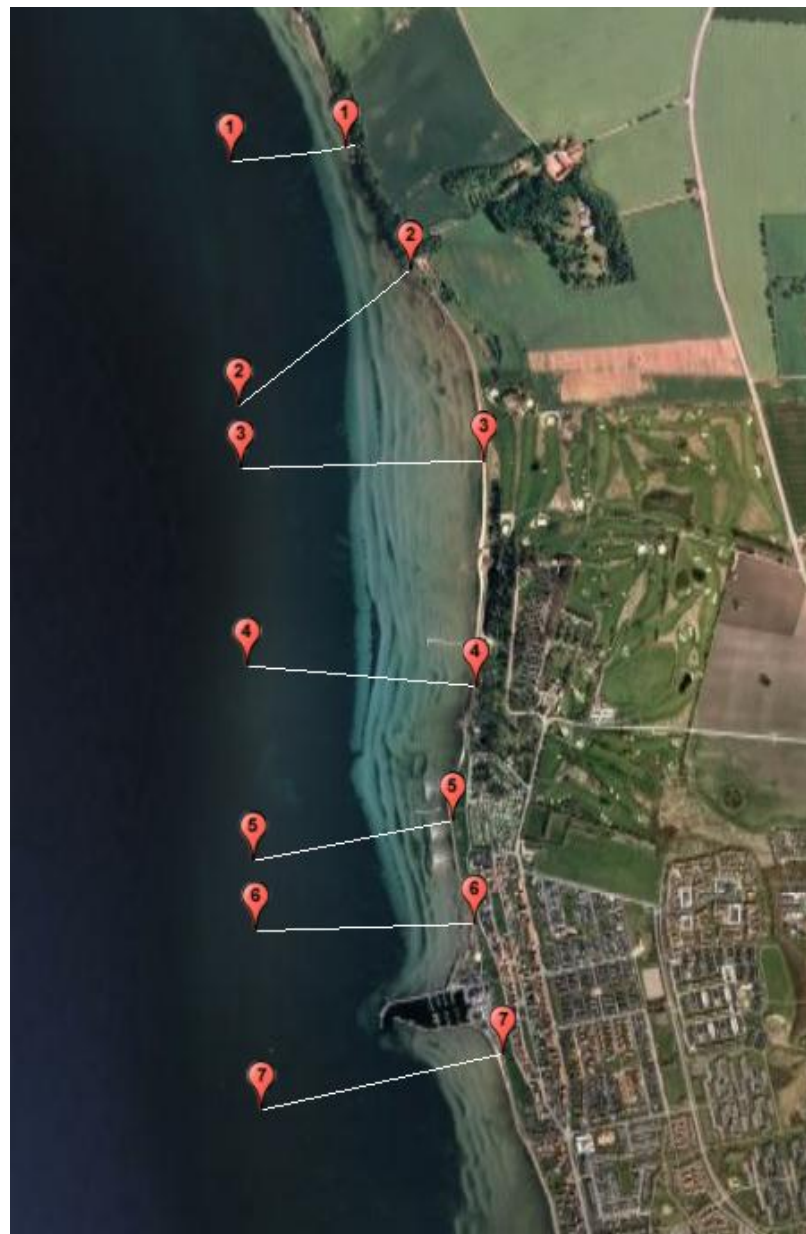
Figur 6-1 Flygfoto med de sju profilerna där sedimenttransporten har beräknats är markerade.
