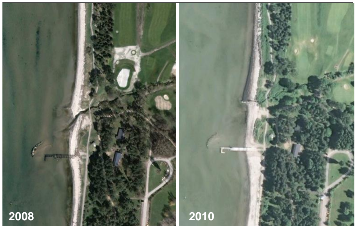
Figur 4-6 Övergången mellan sträcka 2 och 3, flygfoton från 2008 och 2010. Wallabäckens mynning, en vågbrytare ut från stranden och en vågbrytare i havet utanför bryggan syns.
