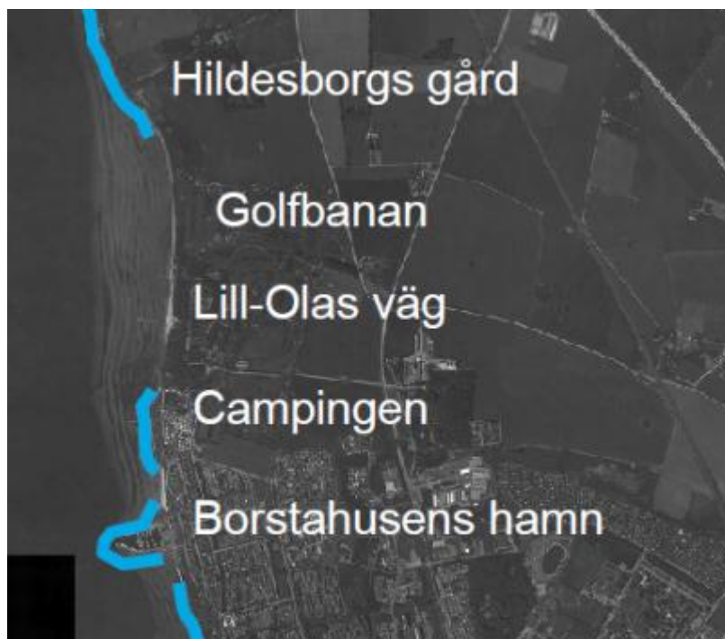
Figur 4-2 Befintligt kustskydd längs aktuell kuststräcka (blått = skydd finns). (Karlsson Green och Martinsson, 2010)
