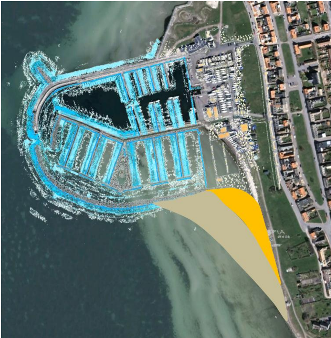
Figur 8-2 Skiss på föreslagen sandutfyllnad (gul) och den förväntade svallzonen (olivgrön) söder om den föreslagna hamnutbyggnaden.
