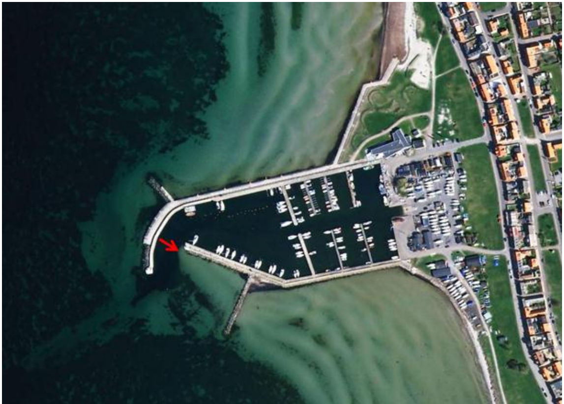
Figur 4-13 Flygfoto av Borstahusens hamn. Den röda pilen visar var igensandningen av hamnens mynning byggs ut från.
